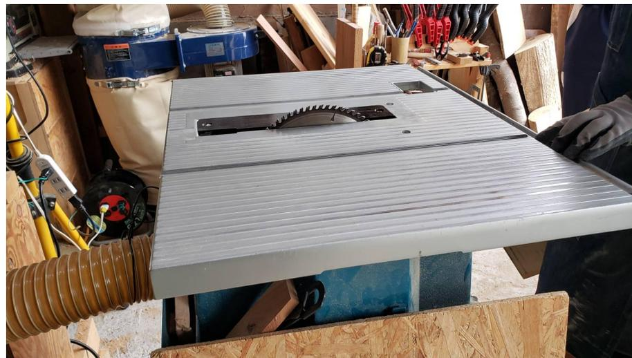
丸鋸盤：中央の刃が高速で回転し、木を切断する。
